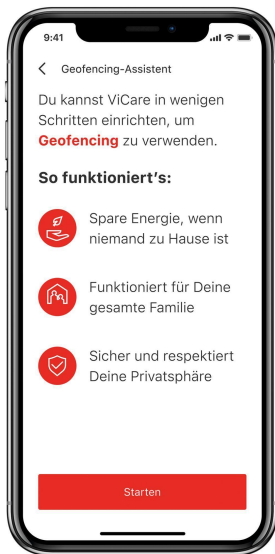
Bild 2: Die ViCare App von Viessmann nutzt auf Wunsch die Ortsfunktion des Smartphones und erkennt die Entfernung zur Heizung (Geofencing), so wird die Heizleistung automatisch gedrosselt, wenn niemand mehr im Hause ist (in Kürze verfügbar).
